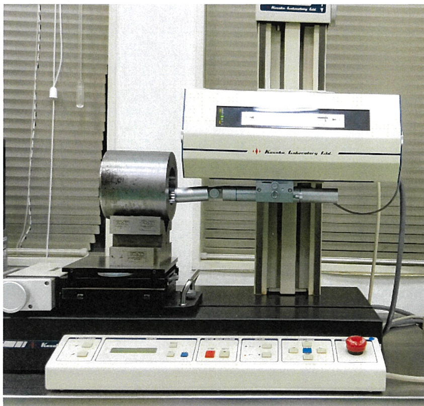
圖 D-1 加工物件表面粗糙度之實際量測情形
